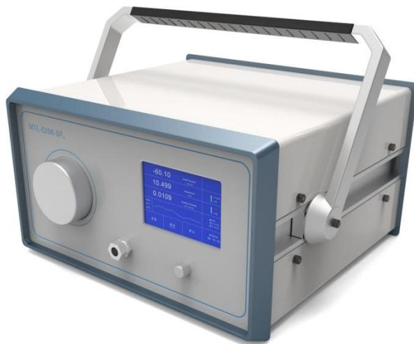
MTL-5206-SF<sub>6</sub>便携冷镜式露点仪是美特瑞公司推出的专用电力行业中六氟化硫(SF<sub>6</sub>)气体中露点测量的精密仪器。产品采用冷镜式原理，智能人机界面控制系统操作，全自动连续分析。MTL-5206-SF<sub>6</sub>型便携冷镜式露点仪精度高、量程广、稳定性好、无漂移特性。在电力行业中，六氟化硫(SF<sub>6</sub>)气体被广泛用于高压开关设备(如断路器、GIS组合电器等)中，因其具有优异的绝缘性能和灭弧能力。
