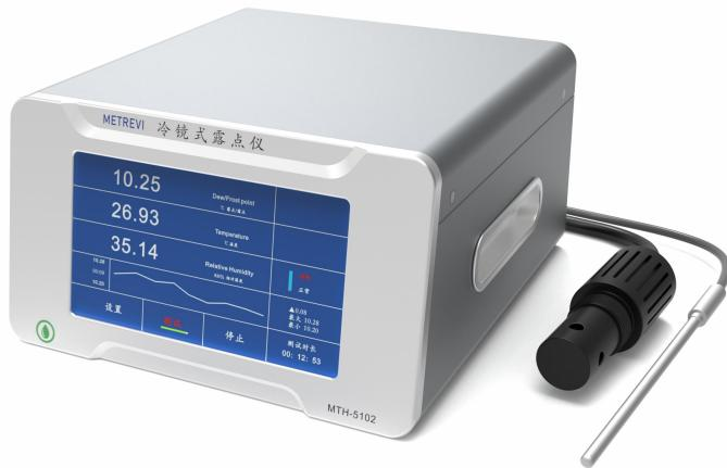
欢迎使用 MTH5102 冷镜式露点仪，其采用冷镜式原理，使用三级半导体制冷片对镜面制冷。当被测气体中的水蒸气随着镜面温度逐渐降低而达到饱和，当镜面温度低于露点值时，凝结速度高于升华速度，露层增厚；反之露层减少。当水蒸气的凝结与升华速度平衡时，镜面温度即为露点温度。
